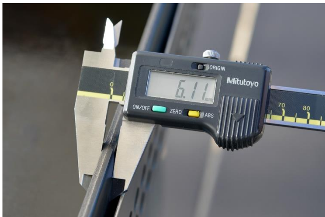
6 mm starke Grillplatte bei der Simogas Extrem E-60.
